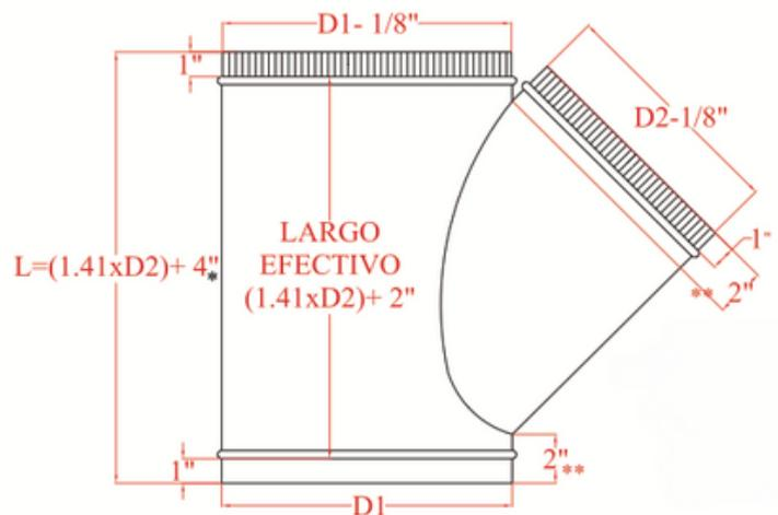
$D1$ =Diámetro de ducto principal,  $D2$ =Diámetro del ramal .
