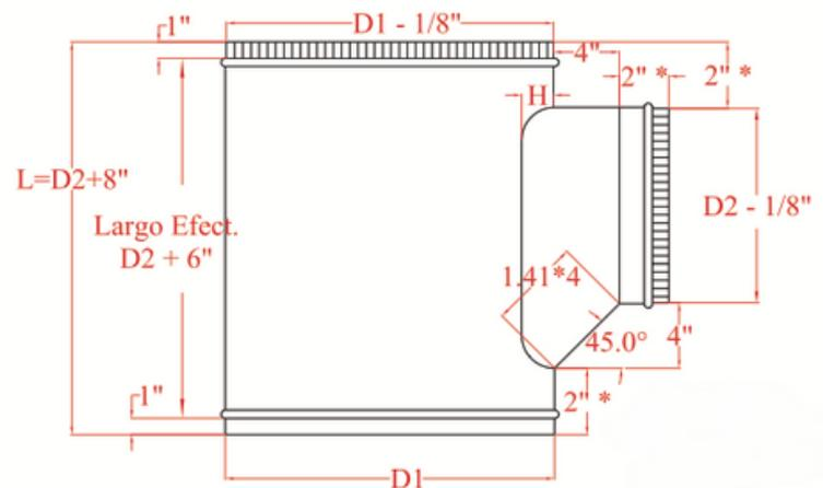
$D1$ =Diámetro del ducto principal,  $D2$ =Diámetro del ramal y  $L$ =Largo total.
